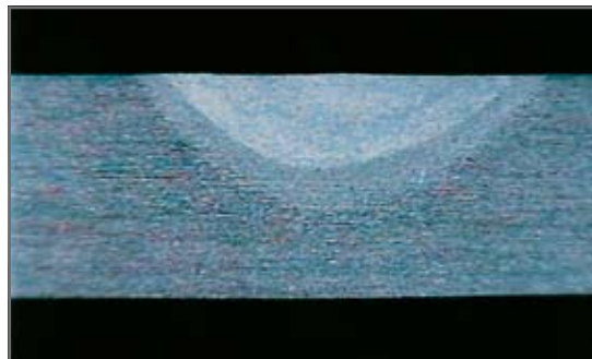
Argon 4.6 Materiaal: Al Mg 4,5 Mn, plaatdikte 5,2 mm; lassnelheid: 30 cm/min, geringe inbranding.
