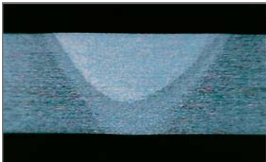
Argon He 11® Materiaal: Al Mg 4,5 Mn, plaatdikte 5,2 mm; lassnelheid: 30 cm/min, diepe inbranding.
